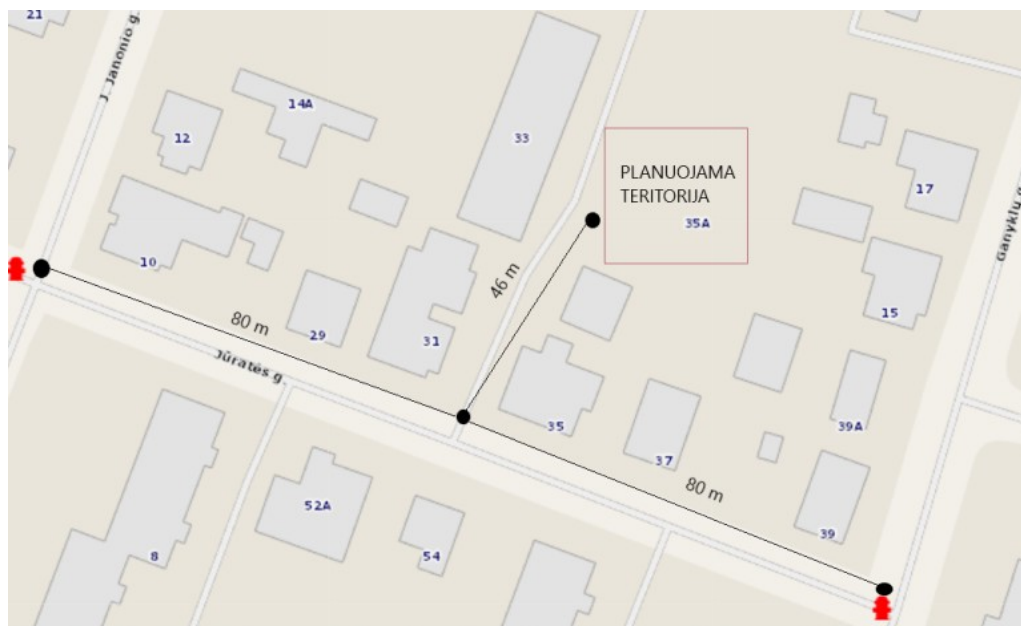
4.4.1 pav. Hidrantų dislokacijos schema planuojamos teritorijos atžvilgiu
