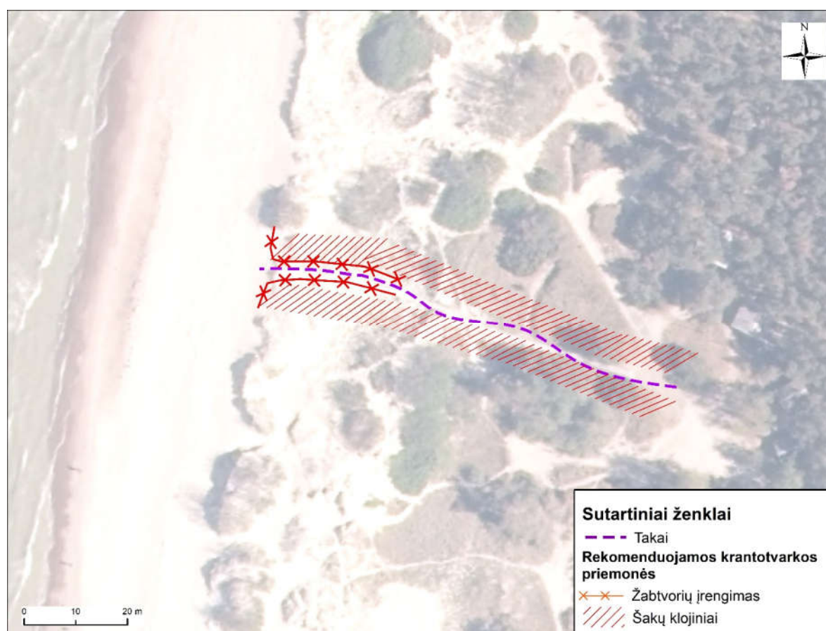
4.0 pav. Atnaujinamų takų šonų dengimo šakų klojiniais bei žabtvių įrengimo takų prieigose principinė schema
