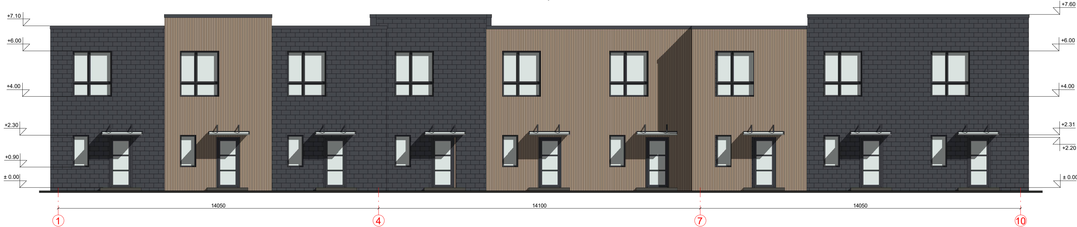
FASADAS TARP AŠIŲ 1-10 M 1:100
