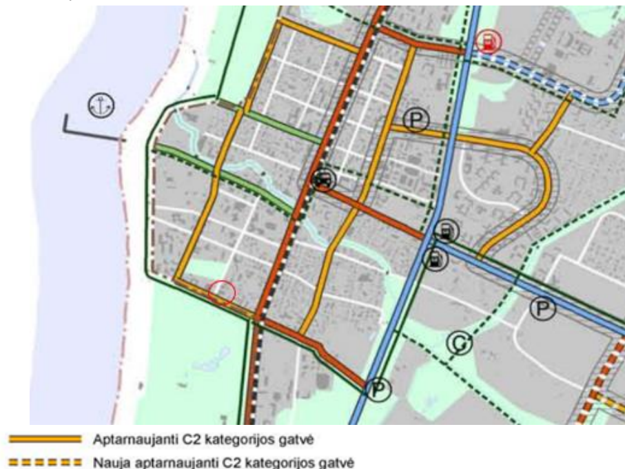
6.1 pav. Ištrauka iš bendrojo plano susisiekimo sistemos brėžinio
