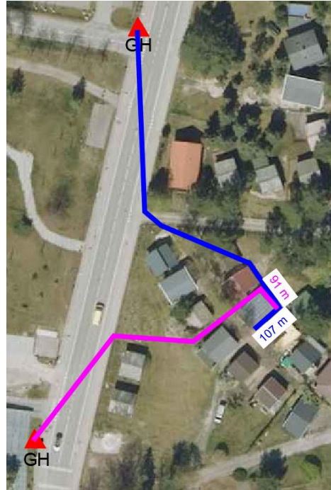
2 pav. Atstumas nuo esamų gaisrinių hidrantų iki tolimiausio pastato taško
