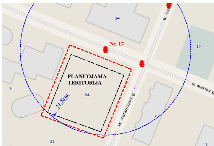
4.5.1 pav. Hidrantų dislokacijos schema planuojamos teritorijos atžvilgiu
