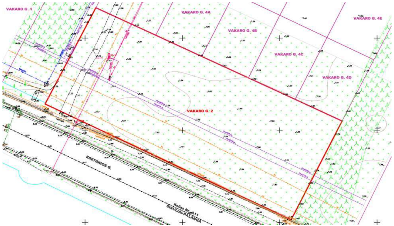
Pav. Planuojamos teritorijos topografinio plano su esama inžinerine ir susiekimo infrastruktūra schema.
